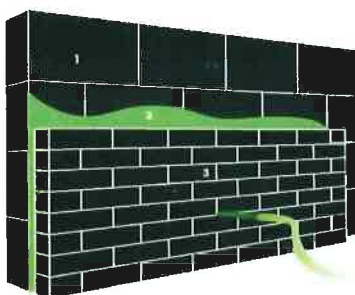
1. Dragende muur | 2. Ingeblazen isolatie | 3. Gevelsteen / gevelbekleding
